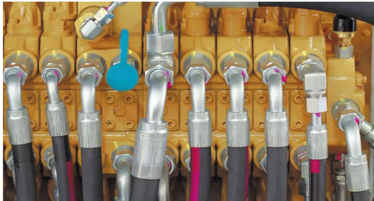
Рукава высокого давления (РВД) – это гибкий трубопровод, главной задачей которого является передача рабочего усилия с помощью гидравлических или других жидкостей.
