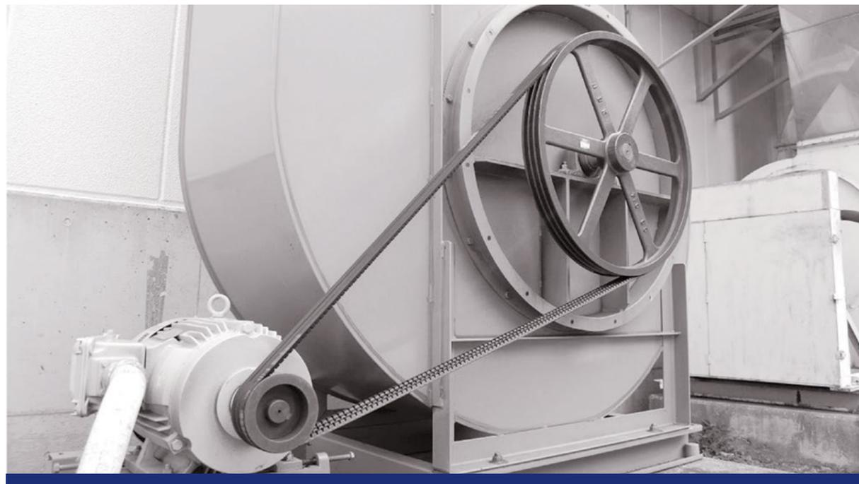
Приводные ремни предназначены для передачи мощности от двигателя к ведомому механизму.
